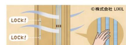
採風部分は網戸がついているので虫が気になる夏場も安心。ドアのカギを閉めたままで採風でき、採風部分は外から手を差し込めないデザインで防犯性にもしっかりと配慮しています。
